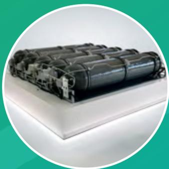
Ce système de stockage d'hydrogène démontre un développement de système complet rapide et robuste avec des normes de qualité élevées. Composé de 5 réservoirs de type IV de 350 bars, il est adapté aux applications véhicules utilitaires. La conception et l'assemblage de ce système comprennent les réservoirs haute pression, le châssis, les auxiliaires, la tuyauterie et les connecteurs, l'électronique, le test d'étanchéité en fin de ligne et les contrôles.
